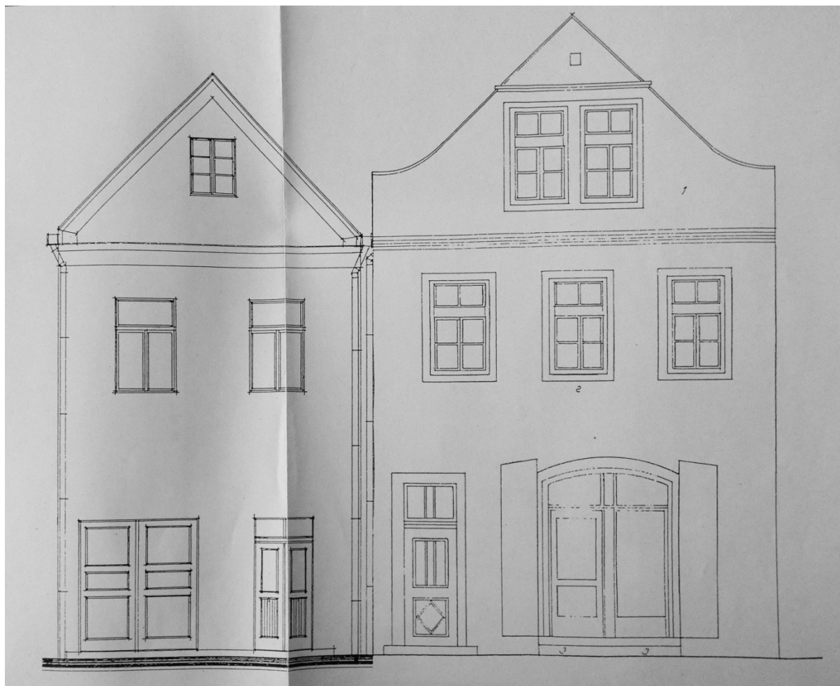
▲ Obr. 15: Stav jižního průčelí domu v roce 1998 z dokumentace úprav zastřešení (MÚ Hradec Králové, Archiv stavebního odboru – Stavební spis domu čp. 179).
